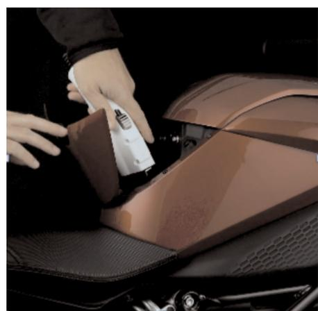
Notre « Système de Charge Rapide » évolutif permet de configurer la moto pour une recharge à 3 kW, 6 kW, 9 kW ou 12 kW sur toute station de charge au standard niveau 2.\*
