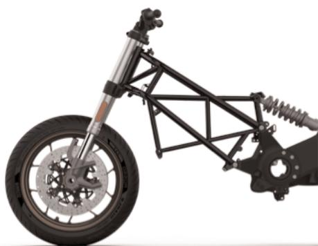
Incroyablement léger. Étonnamment robuste. Le châssis en treillis d'acier, avec bras oscillant sur mesure et suspension Showa évoluée, donne des sensations de conduite aussi athlétiques qu'intuitives.
