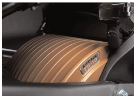
Le moteur ZF75-10 offre 190 Nm de couple et une puissance de 110 ch, pour propulser en toute simplicité la SR/F jusqu'à une vitesse maximale de 200 km/h. L'association de l'architecture sans balais à aimants permanents internes réputée de Zero Motorcycles à une grande compacité avec refroidissement par air passif se traduit par des performances et un rendement en tête de la catégorie.
