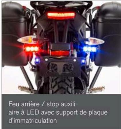
Feu arrière / stop auxiliaire à LED avec support de plaque d'immatriculation
